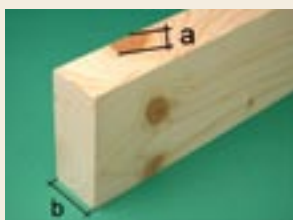
Astmessung. Sortierklasse S 10
