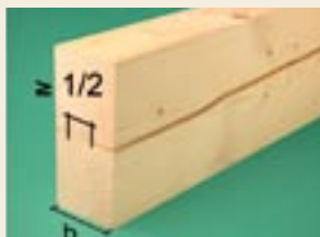
Messung von Schwindrissen. Sortierklasse S 10. Mindestens 1/2 der Breite b rissfrei.
