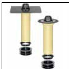
Überbrückungshilfe für defekte Altgullys: Mit 550 mm Bauteillänge durchdringt der SitaSani 165 PUR auf dem Weg zum alten Gullytopf auch dickste Wärmedämmpakete.
